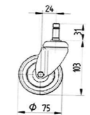
..... Standard castor \phi 75 mm TENTE 2470 .....
